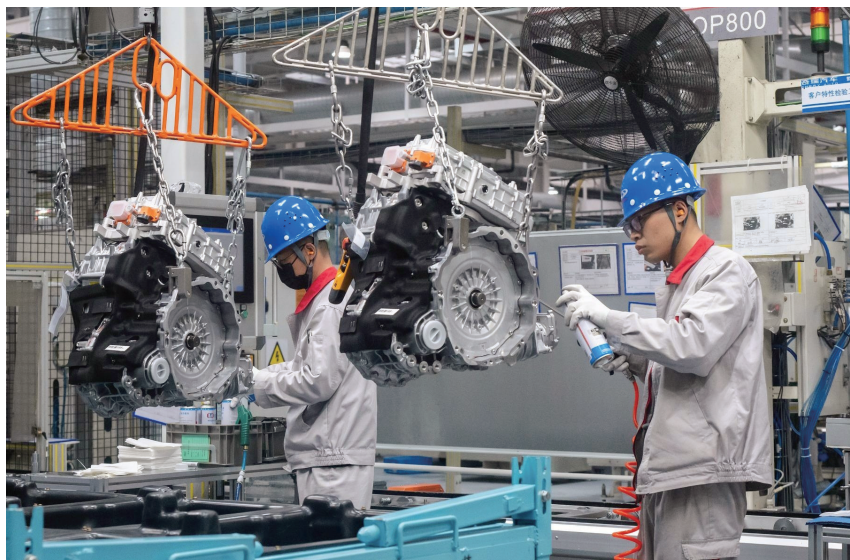
2026年2月24日，在芜湖埃科动力系统有限公司智能生产线上，工人在生产新能源汽车变速箱。
