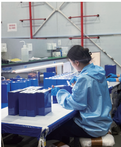
阜阳海钠科技有限责任公司车间里工人正在进行钠离子电池贴片作业。
